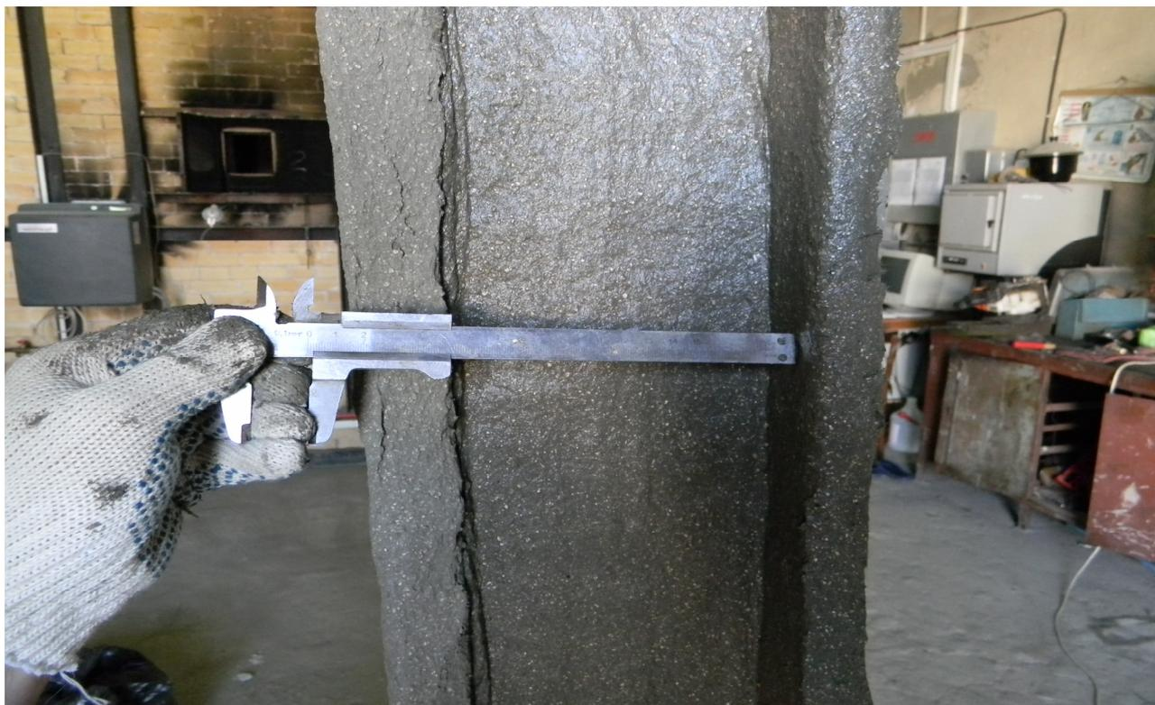
Рис. 1. Измерение толщины покрытия штангенциркулем
